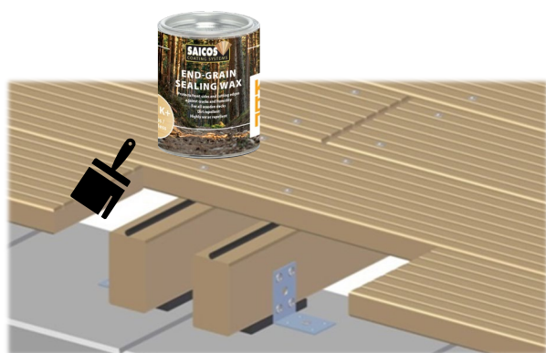
Bild 4: Ändförsegling med Kebony End-Grain Sealing Wax rekommenderas som en del av bästa praxis - detta minskar risken för att ändarna spricker.
