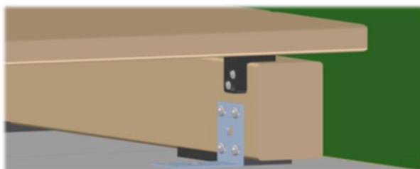
Figur 8: Skruva fast ändclipset i underkonstruktionen
