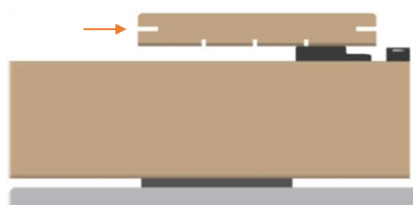
Figur 3: Placera brädan på underkonstruktionen och skjut in läpparna i hållarna.
