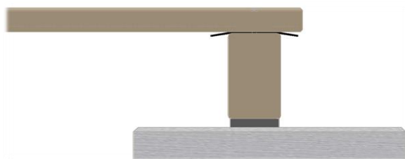
Exempel på användning av fuktspärr. Distans mellan betongplatta och regel. Inpassad syllpapp mellan reglar och altanbräda.
